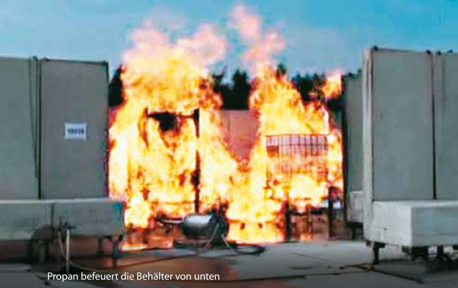
Mit Ethanol gefüllte Edelstahl-IBC und Kombi-IBC vor dem Brandtest
